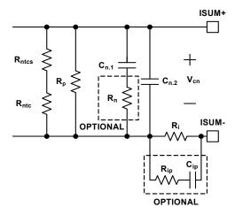
FIGURE 29. OPTIONAL CIRCUITS FOR RINGBACK REDUCTION
