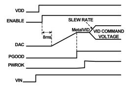
FIGURE 15. TYPICAL SOFT-START WAVEFORMS
