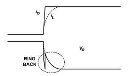
FIGURE 28. OUTPUT VOLTAGE RINGBACK PROBLEM
