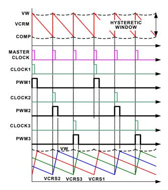
FIGURE 10. R3™ MODULATOR OPERATION PRINCIPLES IN STEADY STATE
